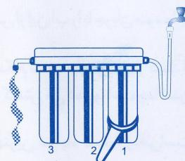
۹) شیر آب را باز کنید تا آب جریان یابد. تا جایی که مزه شوری آن از بین برود. هم اکنون دستگاه برای استفاده مجدد آماده است.
