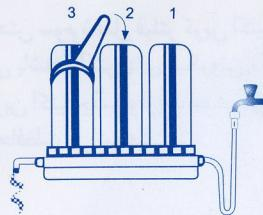
۷) به منظور از بین بردن اثر آب نمک بر کربن و رزین شیر آب را به مدت ۳۰ ثانیه با فشار باز کنید.
